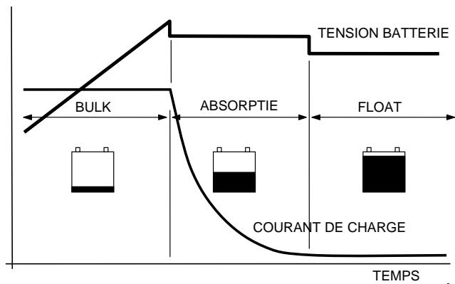
La curva di carico a 3 stadi. Lo stadio A: Bulk è per la carica veloce da 0 all'80%; lo stadio B Absorption, la batteria è caricata dall'80% al 100%; Stadio C: Float, la batteria è mantenuta nello stato di piena carica.
