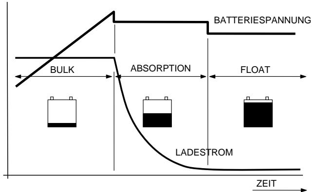
Ladekurve in 3 Stufen: A ist die Hauptladung (Bulk), B ist die Ausgleichsladung (Absorption), in der die Batterien von 80 auf 100% geladen werden, und C ist die Erhaltungsladung (Float).
