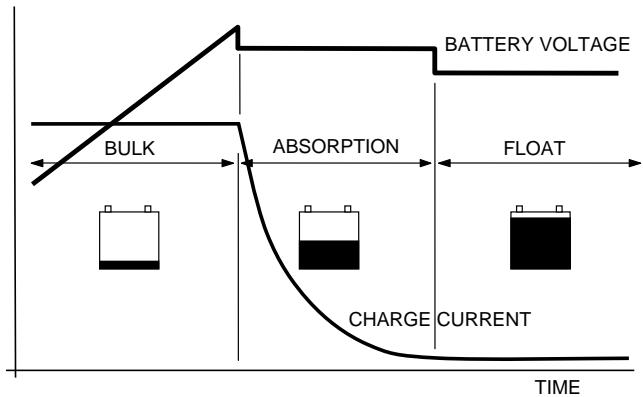
Curva de carga de tres etapas. Fase A: BULK, para carga rápida del 0 al 80%, Fase B: ABSORCIÓN, la batería se carga del 80 al 100%. Fase C: FLOTACIÓN, la batería se mantiene en estado de carga total.
